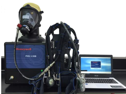
空氣呼吸器檢測
